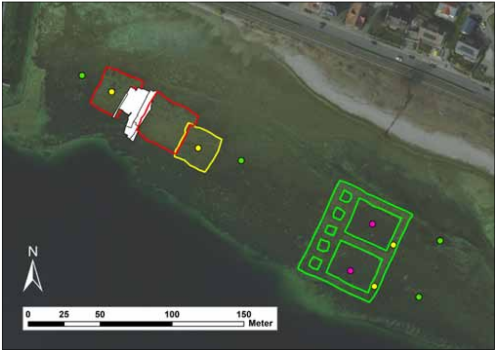
Abb. 2: Beprobungsschema am Beispiel der Station Sipplingen-Osthafen. Farbige Polygone: Schüttungsflächen, grün – Waben und Riegelschüttung 2009, gelb – Flächenschüttung 2010, rot – Flächenschüttung 2011, weiss – Geotextilbahnen. Farbige Punkte – Probennahme-Positionen: gelb – Kies, grün – Referenz (naturbelassenes Sediment), lila – Wabeninnenfläche. Luftbildgrundlage: Landesamt für Geoinformation und Landentwicklung Baden-Württemberg, GIS-Datengrundlage: LAD BW.
